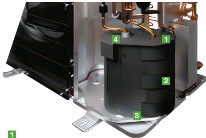
Cztery warstwy gumy i filcu pokrywające obudowę sprężarki pochłaniają hałas.
